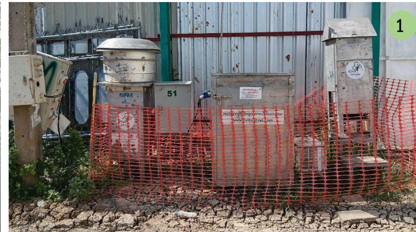
จุดตรวจวัดคุณภาพอากาศทั่วไปและความสั่นสะเทือน บริเวณพื้นที่ก่อสร้างโครงการ
